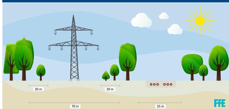
Während Freileitungen aus Kostengründen hauptsächlich in der Mittel- bis Hoch- und Höchstspannungsebene vorkommen, werden Erdkabel aus Akzeptanz- und Platzgründen vor allem im Nieder- bis Mittelspannungsbereich verlegt. Die beiden Leitungsarten unterscheiden sich außerdem durch folgende Eigenschaften (Tabelle 12):
